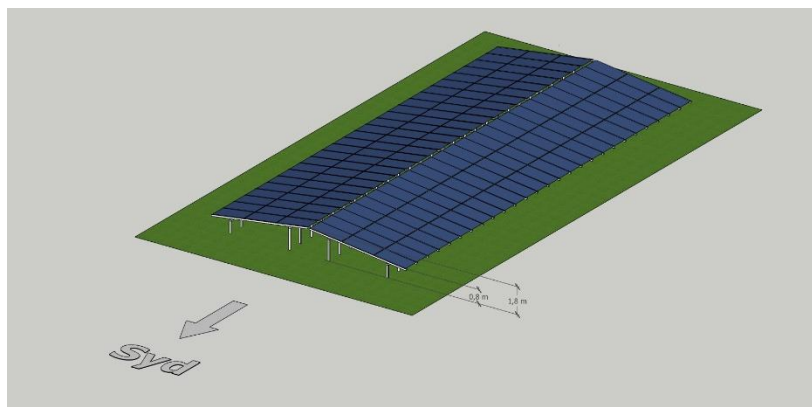
Figur 3-9. 3D illustration af række med Fixed-tilt E/W opstilling.. Kilde: Ecosolar.
